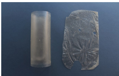
Рис. 5. Пленки из капша каррагинана, ксантановой камеди и глицерина в соотношении 2:1:1 (слева) и 2:2:1 (справа) (фото автора)
