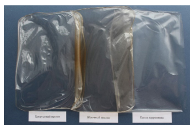
Рис. 12. Однокомпонентный пластик: цитрусовый пектин (слева), яблочный пектин (в центре), каппа каррагинан (справа) (фото автора)
